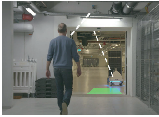
左图：MiR AI Camera 检测到应对其做出反应的一个物体，阻止 MiR 机器人穿过红色标记区域。右图：MiR 相机检测到一个不必对其做出反应的人，因为这个人能够有效避开机器人。在这种情况下，MiR 机器人可以穿过绿色标记的区域。
